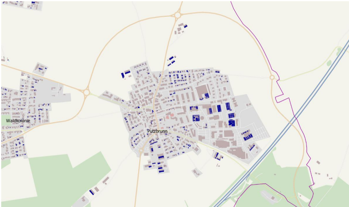
Abbildung 58: Dachflächenphotovoltaik und Solarthermie in Blau im Ortszentrum im Jahre 2022. (Eigene Darstellung)
