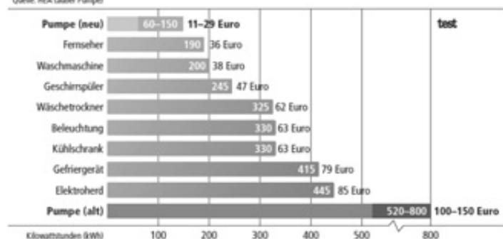
**Tipp:** Sichern Sie sich mindestens 50 Euro. Diesen Zuschuss gibt die Gemeinde Putzbrunn für den Austausch der alten Pumpe in eine Hocheffizienzpumpe. Die Kosten liegen bei ca. 250 € netto pro Pumpe unter „normalen Bedingungen“, d.h. 2 Absperrhähne und freier Zugang. Bei größeren Pumpen oder erschwerten Bedingungen können Mehrkosten entstehen.
